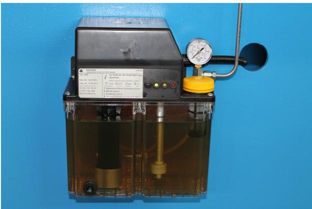
Zentralschmieraggregat zur Schmierung des Leitpatronensystems zur Gewährleistung höchster Lebensdauer
