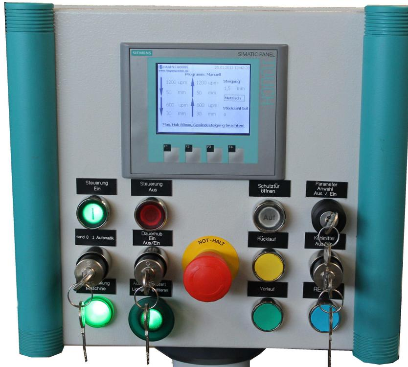
Funktionales Bedienfeld zur einfachen Steuerung, Kontrolle und Anpassung aller Maschinenfunktionen
