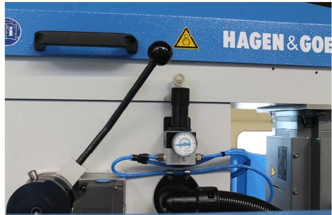
Pneumatischer Gewichtsausgleich zur Kompensierung von Gewichtbelastungen durch Anbau von z.B. Mehrspindelköpfen
