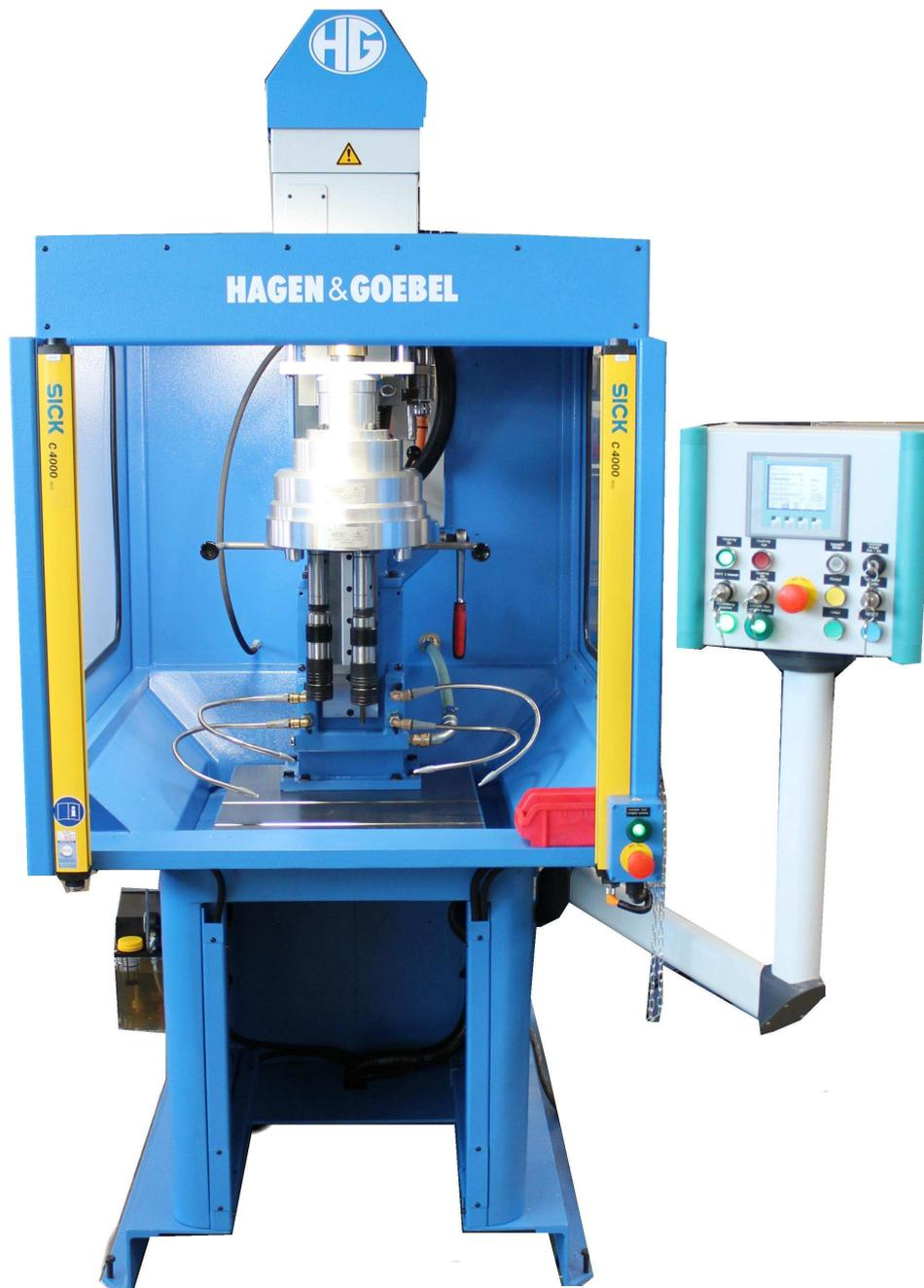
(Das Maschinenbild zeigt die Hochleistungs-Gewindemaschine HG-22 Servo mit umfangreicher Zusatzausstattung)
