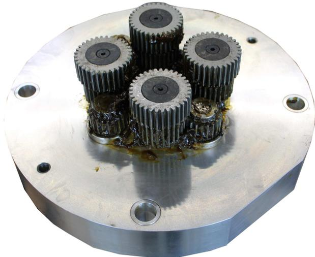
Werkstückspezifische Wechsellplatten des Mehrspindelkopfes
