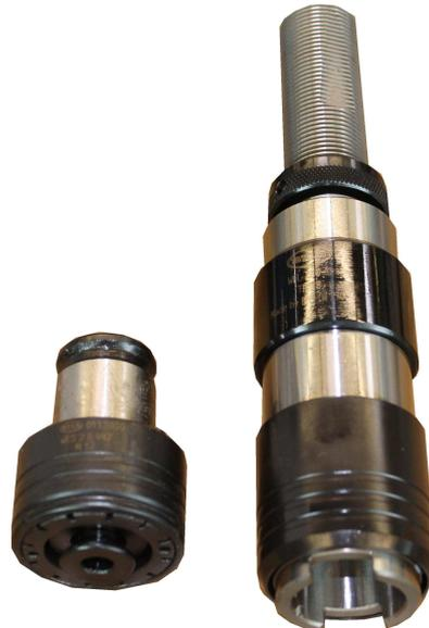
Gewindeschneid-Schnellwechselfutter mit einstellbarer Sicherheitskupplung
