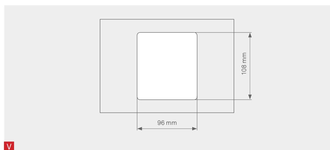
Fräsmäße Flächenbündiger Einbau | Milling dimensions Flush-mounted | Dimensions de fraisage Montage encastré
