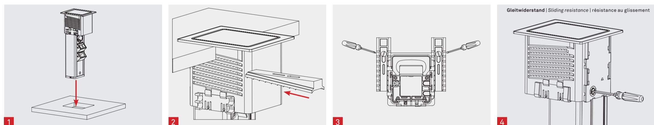
Kabelführung | Cable routing | Guide de câble
