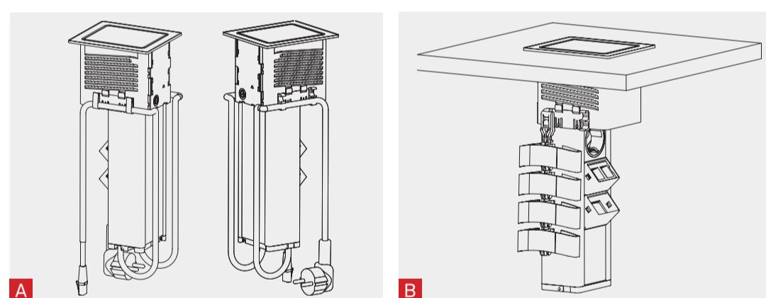
Austausch Wechselmodul | Replacement of an interchangeable module | Remplacement d'un module interchangeable
