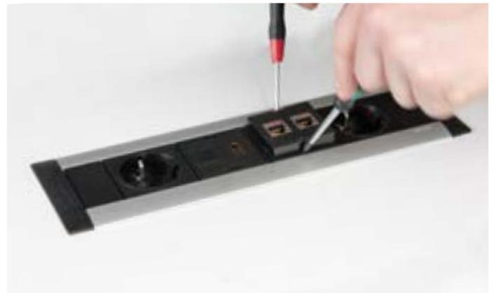
Das Wechselmodul wird mit einfachen Mitteln aus der Halterung gelöst. Der Weg für ein neues Wechselmodul in Ihrem EVOLine System (hier FrameDock) ist nun frei.
