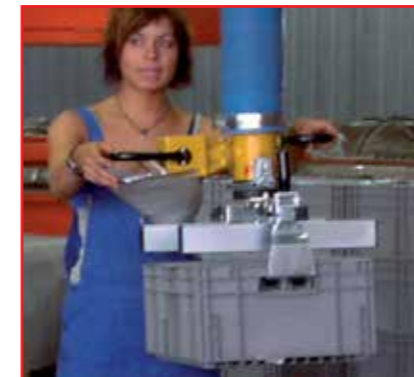
mechanischer Kistengreifer für Kisten mit Traglaschen
