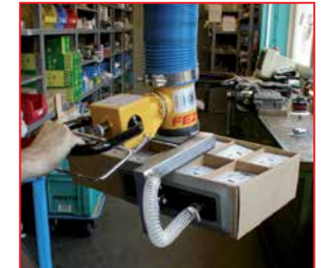
Sonder-Sugfuß für die seitliche Aufnahme von Kartonagen
