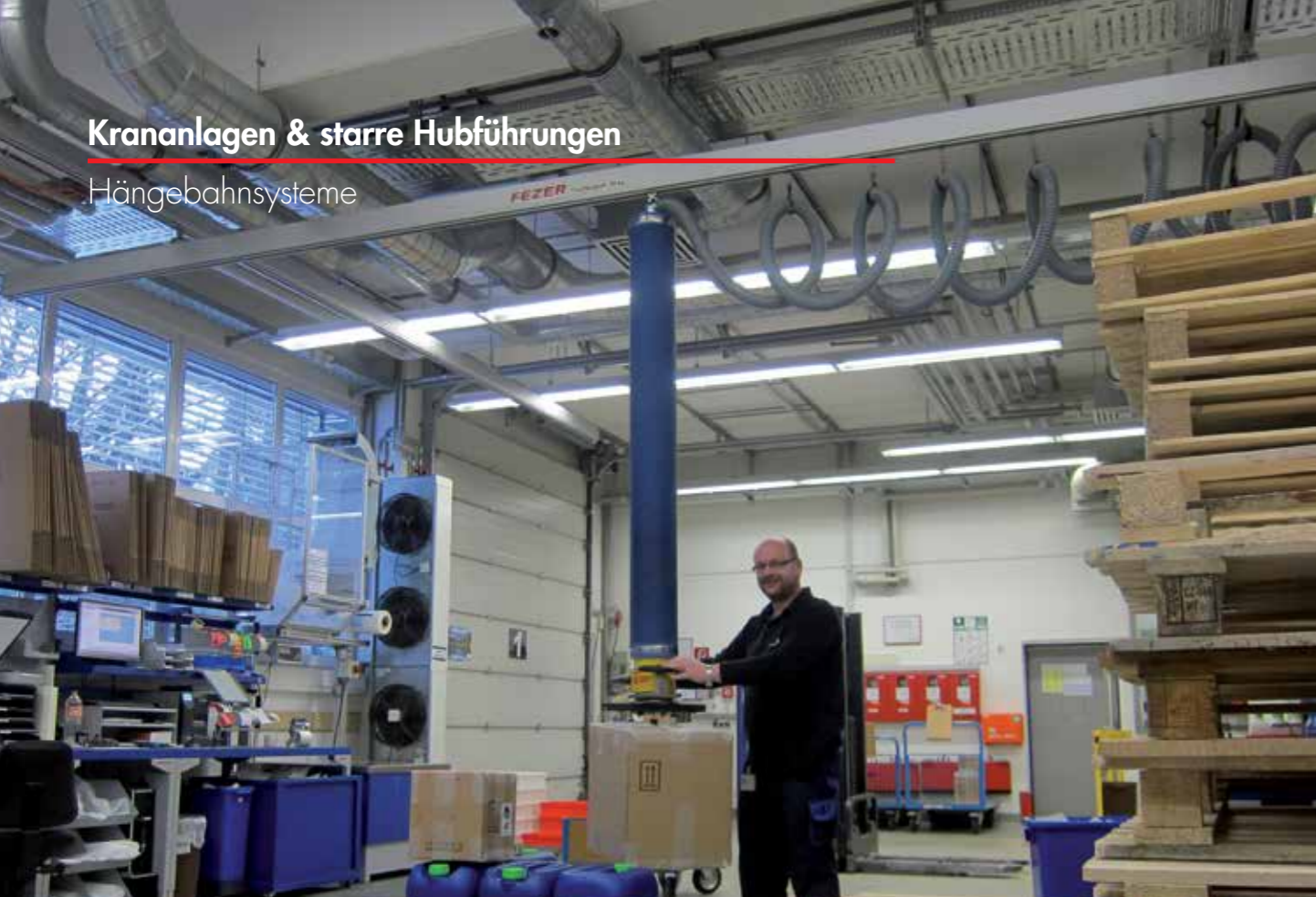
Einträger-Hängebahnsystem mit Schlauchheber VacuPowerlift
