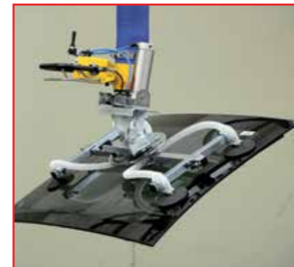
pneumatische Schwenkvorrichtung zum Schwenken von Werkstücken um 90°
