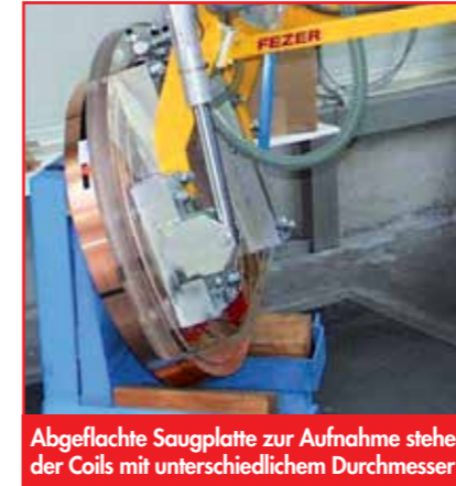
Durchblick: Saugplatte mit Sichtfenster
