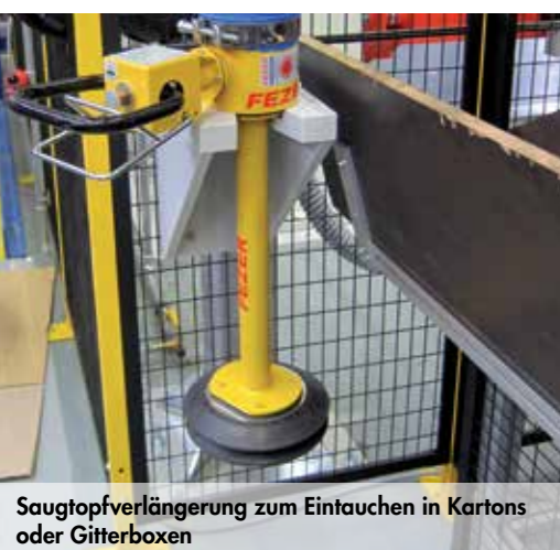
Saugtopfverlängerung zum Eintauchen in Kartons oder Gitterboxen
