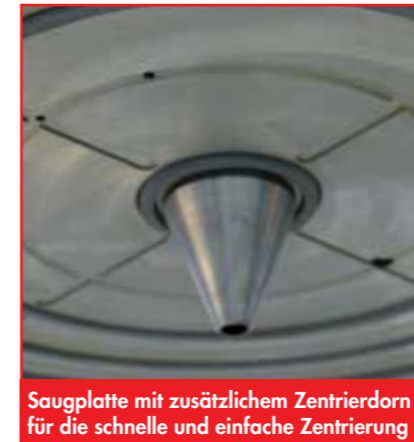
Saugplatte mit teleskopierbarem Zentrierdorn bei unterschiedlichen Hülsendurchmessern
