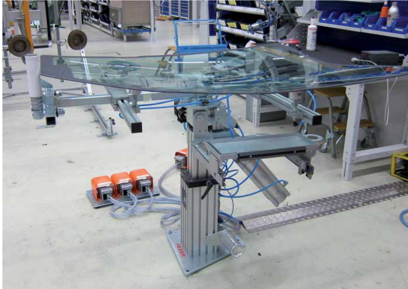
VacuStand VS-I mit pneumatischer Schwenkvorrichtung für die Montage von Seiten- und Heckscheiben in der Automobilindustrie
