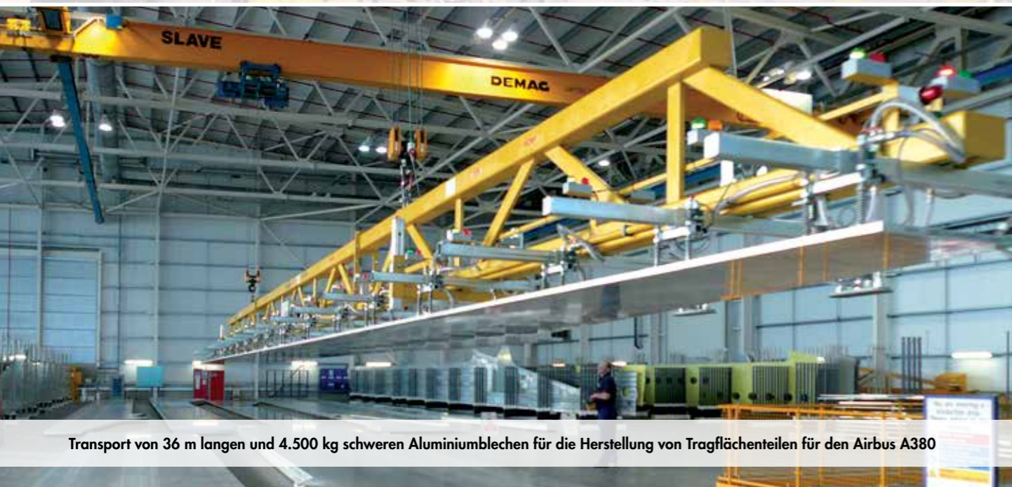
VacuGiant mit 12.000 kg Tragfähigkeit und elektromotorisch ausziehbaren Längsträgern von 8 auf 12 m an einem Recker
