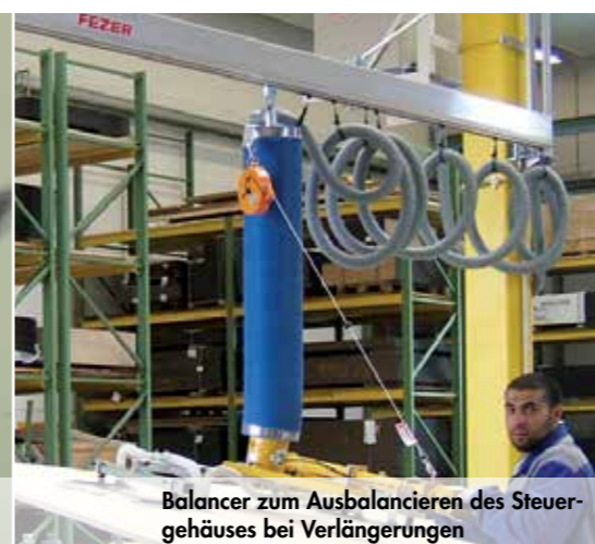
Balancer zum Ausbalancieren des Steuergehäuses bei Verlängerungen
