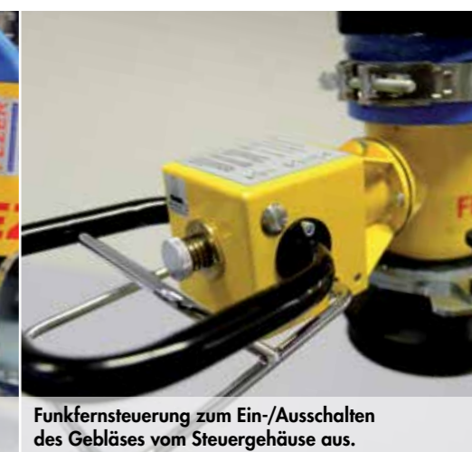
Funkfernsteuerung zum Ein-/Ausschalten des Gebläses vom Steuergehäuse aus.
