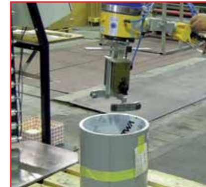
pneumatischer Greifer für das Handling von Coils oder Rohren
