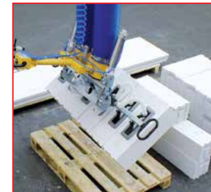
Sonder-Saugfuß für das gleichzeitige Handling mehrerer Betonsteine
