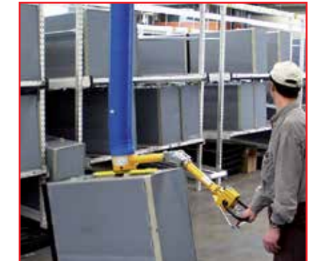
Gelenk für Steuergehäuse bei der Handhabung von hohen Stapelhöhen
