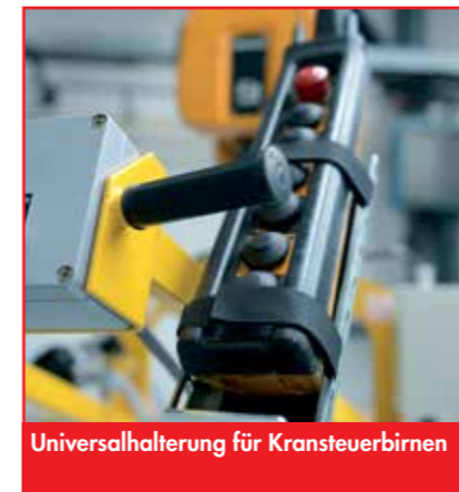
Direktsteuerung für Kranbewegungen über Drucktaster im Manipuliergriff
