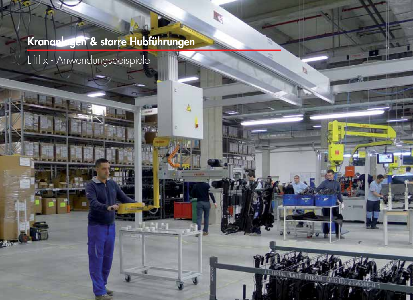
Liffix mit mechanischem Greifmittel für das Handling von Sitzgestellen für die Automobilindustrie
