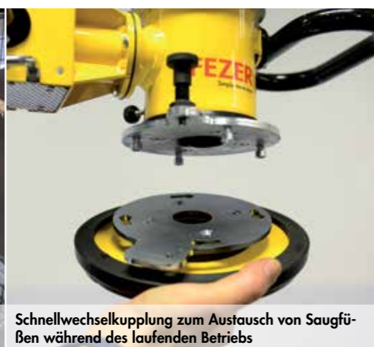
Schnellwechselkupplung zum Austausch von Saugfüßen während des laufenden Betriebs
