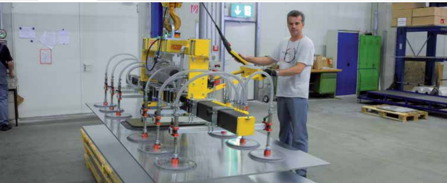
VacuBoy für die Kommissionierung von Stahlblechen bis 2.000 kg
