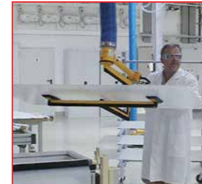
mechanischer Greifer als Untergreifvorrichtung für Glasscheiben
