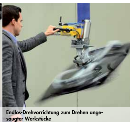
Endlos-Drehvorrichtung zum Drehen angesaugter Werkstücke
