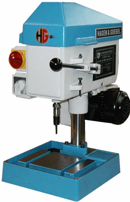
Gewindemaschine HG-6 in Tischausführung mit polumschaltbarem Motor (Drehzahl 355-1800 U/min.)
