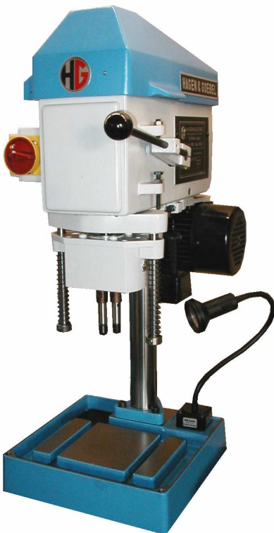
Gewindemaschine HG-6 in Tischausführung mit verstellbarem Zweispindelkopf und Halogenleuchte
