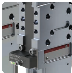
Vor Ort einstellbarer Öffnungswinkel, hier mit induktiver Abfragung
