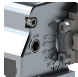
Manuelles Öffnen/Verriegeln des Spanners Schutzrechte angemeldet
