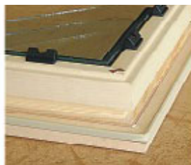
Beleimen der Gehrungsfläche, Rahmenteile zusammenstecken und mit Hoffmann-Schwalben nach Vorgabe verbinden...
