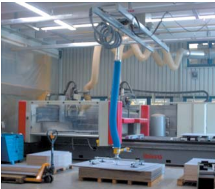
Hängebahnsystem mit Deckenabhängung und Doppelbrücke. Arbeitsfläche: 8.000 x 5.000 mm
