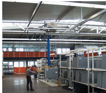
Hängebahnsystem mit Doppelbrücke und Deckenabhängung. Arbeitsfläche: 18.000 x 5.000 mm
