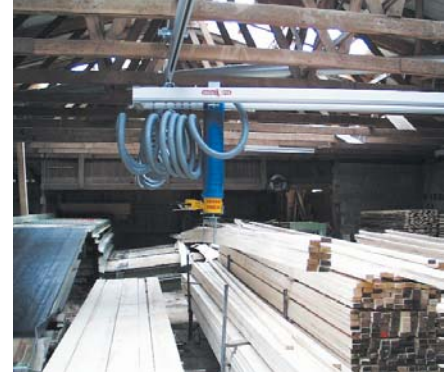
Hängebahnsystem mit Balkenabhängung. Arbeitsfläche: 10.000 x 8.000 mm
