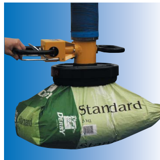
VacuPowerlift VPL mit Vierfach-Saugfuß SFV 115 FBS in Faltenbalgausführung für verklebte und offene Faltpakete.
