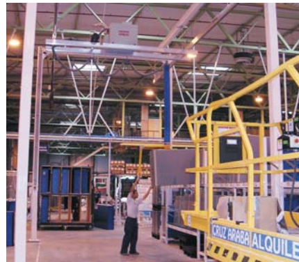
Hängebahnsystem mit selbststehender Portalkonstruktion. Arbeitsfläche: 22.000 x 5.000 mm
