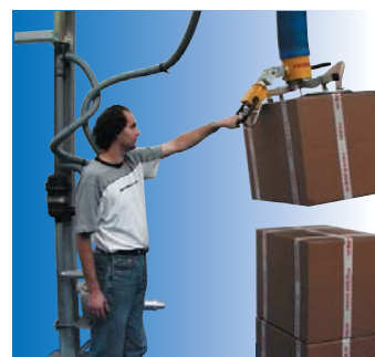
Gelenkige Verlängerung: Zum Stapeln in großer Höhe
