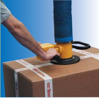
VacuPowerlift VPL mit Einzel-Saugfuß in Faltenbalgausführung SFE 250 FBS für verklebte oder unreife Kartons.
