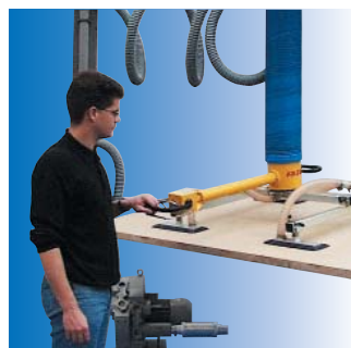
VacuPowerlift VPL mit Vierfach-Saugfuß SFV 120x320 und starrer Verlängerung für großflächige Transportgüter.
