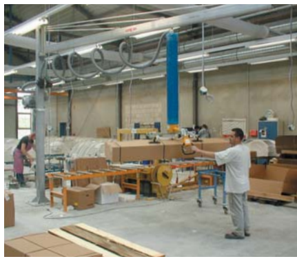
Säulenschwenkkrane SSK 125-4.000 für Lasten bis 80 kg
