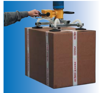
VacuPowerlift VPL mit Vierfach-Saugfuß SFV 115 FBS in Faltenbalgausführung für verklebte und offene Faltpakete.
