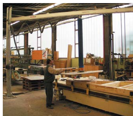
Säulenschwenkkrane SSK 160-6.000 für Lasten bis 80 kg
