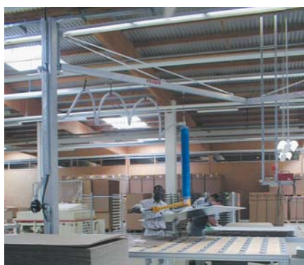
Säulenschwenkkrane SSK 125-4.000 für Lasten bis 60 kg
