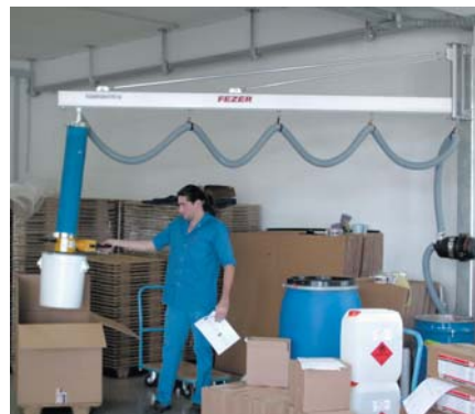
Säulenschwenkkrane SSK 125-4.000 für Lasten bis 40 kg
