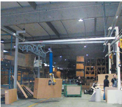
Hängebahnsystem mit selbststehender Portalkonstruktion. Arbeitsfläche: 10.000 x 4.000 mm
