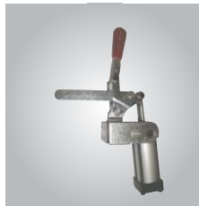
Pneumatiku szorító kézi kezelő karral manuális és automatikus üzemmóddhoz.
